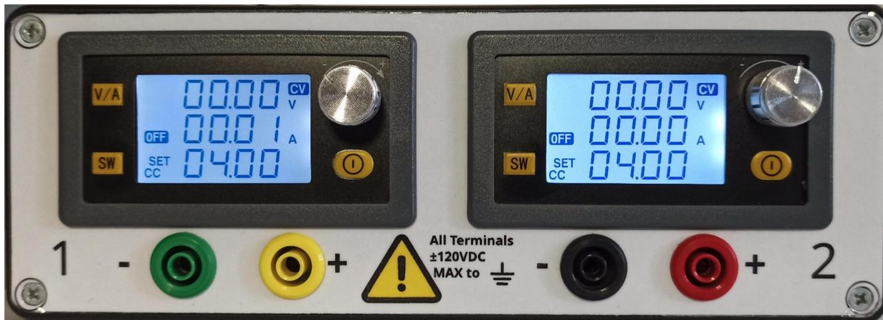
Cette alimentation pilotable et modulable a pour but d'alimenter un dispositif de test de composant de puissance BiGaNver (ISGE). Pour faire ces tests il faut disposer d'un grand nombre d'alimentations flottantes
